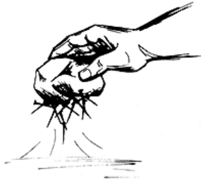
Magnetit je jedna prirodno namagnetisana ruda. Njegova namagnetisanost se pokazuje privlačenjem gvozdениh eksера.
